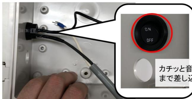
ケーブルグラウンド (S7) のリング部分を外して、プラボックスの内側 (波動スイッチの下) にあてがいます。そこへ**プラボックスの内側から電源ケーブルの丸端子が通った方を通して**ケーブルグラウンドのリングを締めます。ケーブルグラウンドは M16 と M12 の 2 種類があり中央のリングに種類が刻印されています。
