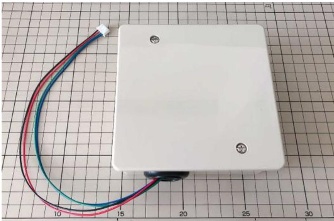
CO2 センサ基板を入れたアウトレットボックスから出ているワイヤハーネスをグローメットを通してプラボックスの中へ入れます。内気象ノード専用基板のコネクタに差し込みます。軽く引っ張っても取れないことを確認してください。
