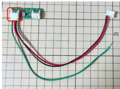
接続ハーネス（短）の緑線フェルール端子は、内気象ノード専用基板の CH1+、CH2+、CH3+、CH4+のいずれかへ接続します。その後、対応するジャンパピンを取り付けます。（CH は+と-があります。必ず+に接続してください。）
