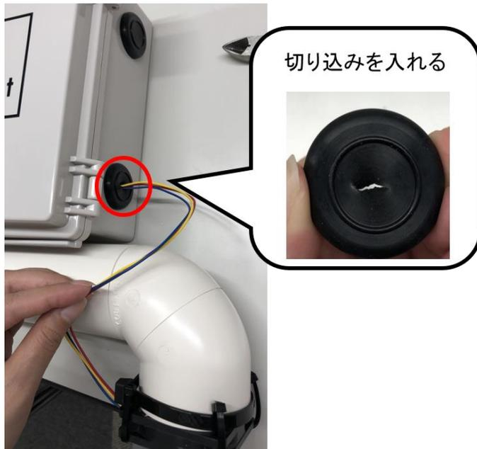
ボックスの中に入れたファンの配線を内気象ノード用基板の端子台へ取り付けます。配線が3本のファンは以下の通りに取り付けます。赤線は VCC へ、黄線は IO2 へ、青線は GND へ取り付けます。
