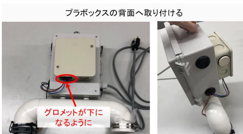
CO2 センサ (HG モデル) の取り付けが完了です。
