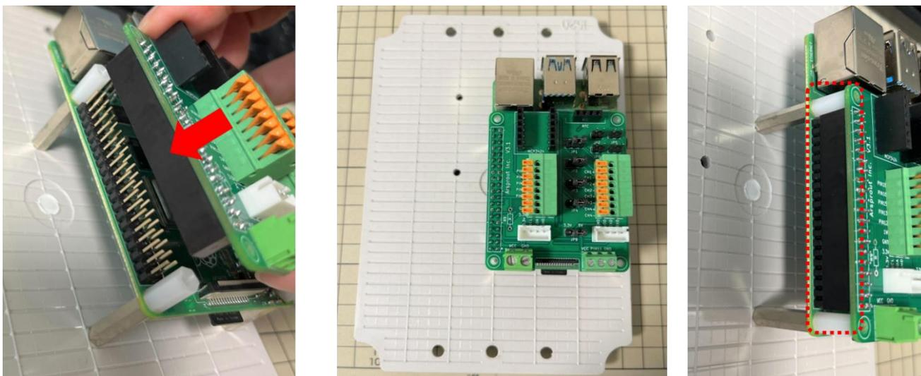
内気象ノード専用基板の四隅を樹脂ネジ (S4) で固定します。
