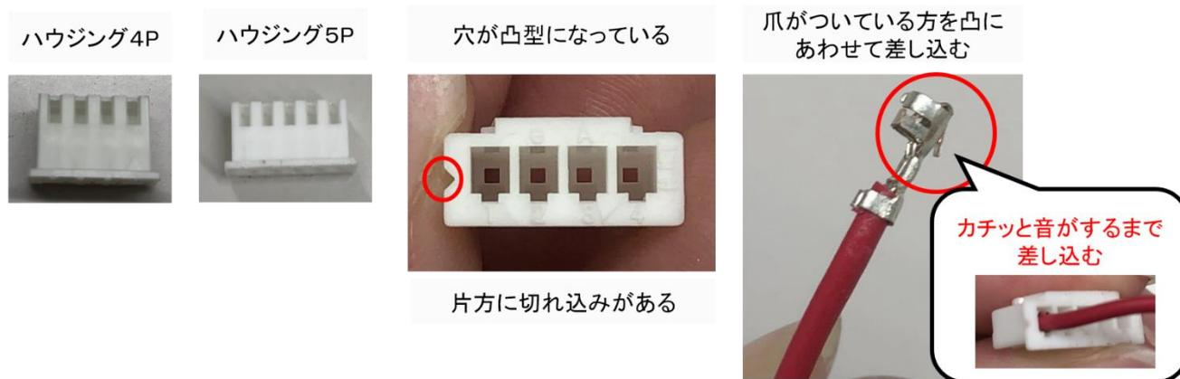
ワイヤハーネスのプラボックス側に**ハウジング 4P (赤、緑、青、黒の並び)** を接続します。次に、強制通風筒側に**ハウジング 5P (赤、青、緑、未接続、黒の並び)** を接続します。線の並び順はハウジングの切れ込みを左にした順番です。
