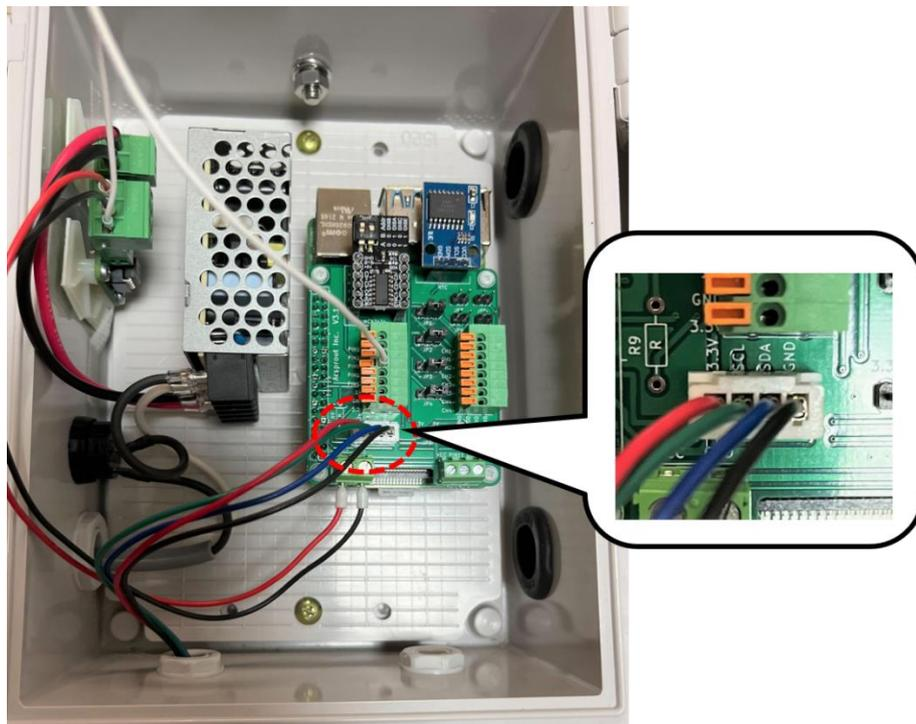
温度センサ (S21 または S25) を強制通風筒側のハウジング 5P へ取り付けます。取り付ける前に、ベース付きポストのピンがまっすぐに並んでいることを確認してください。(曲がっていればラジオペンチ等で修正してください。) 湿度センサにカチッと音がするまで差し込み、軽く引っ張っても取れないことを確認してください。
