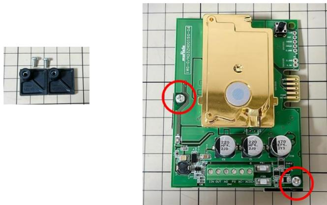
CO2 センサに接続ハーネス (長) を以下の通り接続します。(緑を OUT、黒を FG、赤を ACDC+へ接続)
