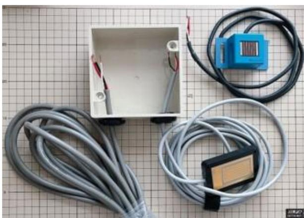
キャプタイヤケーブルと日射センサケーブルを結線します。
