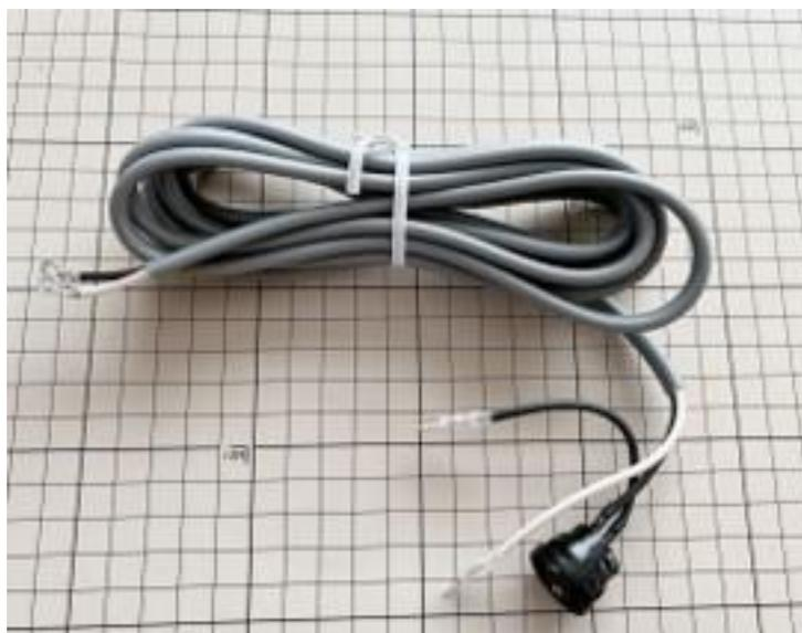
プラボックス側面の穴（切れ込みがある方）に電源ケーブルの丸端子がついた方を通し、波動スイッチをプラボックスに固定します。**ON が上**になるようにはめ込みます。波動スイッチはカチッと音がするまで**しっかりと差し込んで固定**してください。
