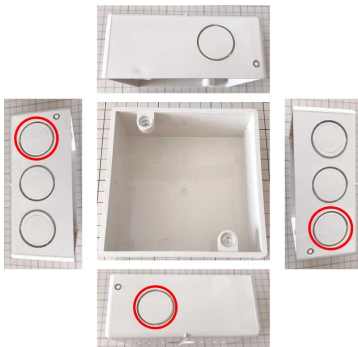
穴開けはロックアウト穴にドライバーを当て、金槌でドライバーの柄を強めに叩くと穴が開きます。使用するドライバーは、貫通ドライバーなど、強く叩いても壊れないものをご使用ください。机の上では衝撃が吸収されて開けにくいので床の上などで作業を行ってください。
