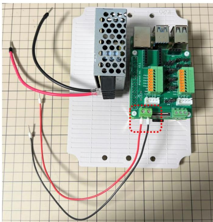
白コードを内気象ノード専用基板の入力用ターミナル PIN13 へ接続します。
