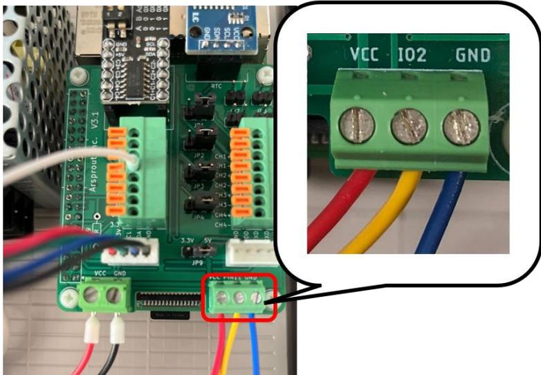
配線が 2 本のファンは以下の通りに取り付けます。赤線は VCC へ、黒線は GND へ取り付けます。
