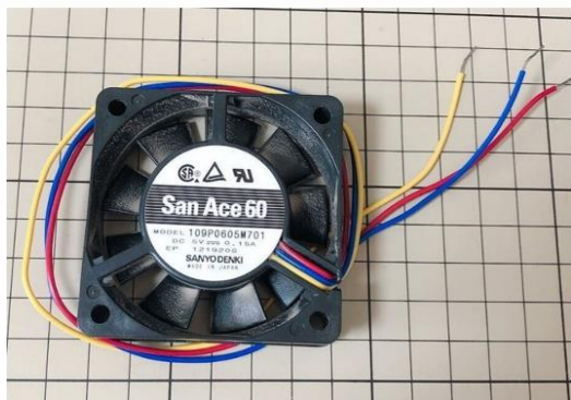
配線が赤線、青線、黄色線3本のファン
