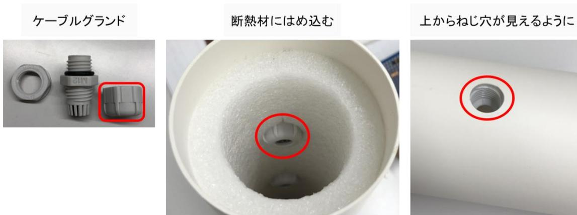
ケーブルグラウンドのキャップ部分のねじ穴に、ケーブルグラウンドの本体を軽くねじ込みます。軽く引っ張っても取れないことを確認してください。きつくねじるとケーブルグラウンドの穴が小さくなりケーブルを通しにくくなります。
