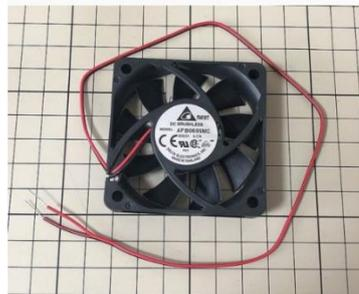
ファンの四隅に結束バンド（細）を通します。まだ仮留めだけで強くは結束しないで下さい。4本の結束バンド（細）に対して、結束バンド（太）をぐるっと回します。こちらもまだ仮留めだけで強くは結束しないで下さい。ファンをエルボとくっ付けて、結束バンドを強く締め込みます。締め込んだら、結束バンドの先端をニッパなどでカットします。これでファン部は完成です。
