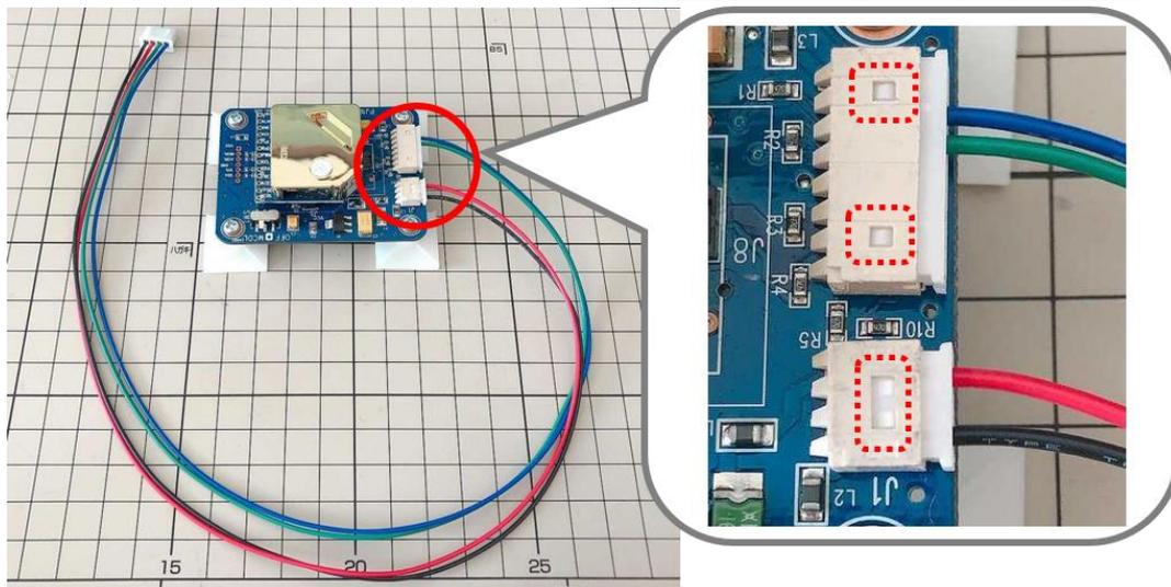
貼り付けボスの裏面シールをはがし、CO2 センサ基板をボックスに貼り付けます。ワイヤーハーネスコネクタはグロメットからボックスの外に出します。
