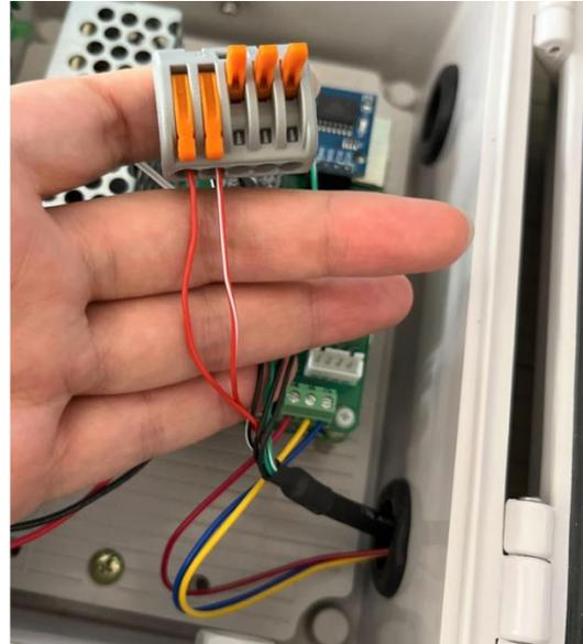
ワンタッチコネクタを使用して結線する箇所があります。使用方法は以下を参照してください。爪を上げるのには力がいりますが、めったに壊れることはないのでパチッと音がするまで爪を上げてください。結線する配線は中の銅線が1cm程度見えるくらいに剥いておいてください。結線後は引っ張っても抜けないことを確認してください。
