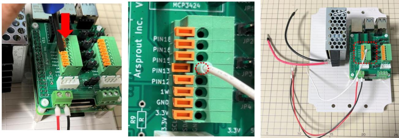
電源ケーブルの白コードをスイッチング電源の N へ接続し、電源ケーブルの黒コードをスイッチング電源の L へ接続します。
