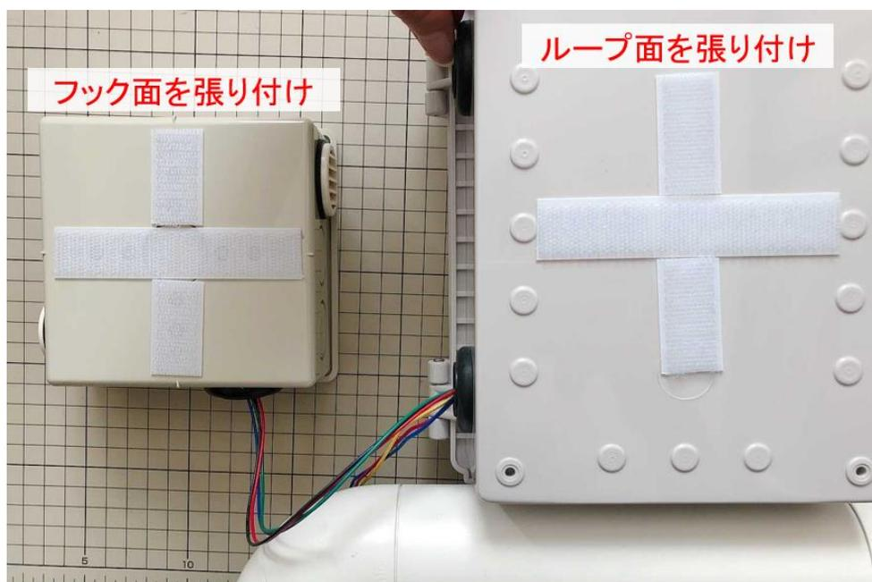
両ボックスの面ファスナー位置に注意しながらしっかり固定して下さい。(CO2 センサボックスはグロメットが下になるように取り付けてください。)
