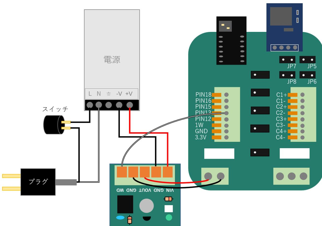
ウォッチドック基板と内気象ノード専用基板を繋ぐ配線が邪魔にならない様にまとめます。マウントベースと結束バンドで配線類を固定します。結束バンドの余った部分はニッパなどでカットします。(下図はイメージです。)
