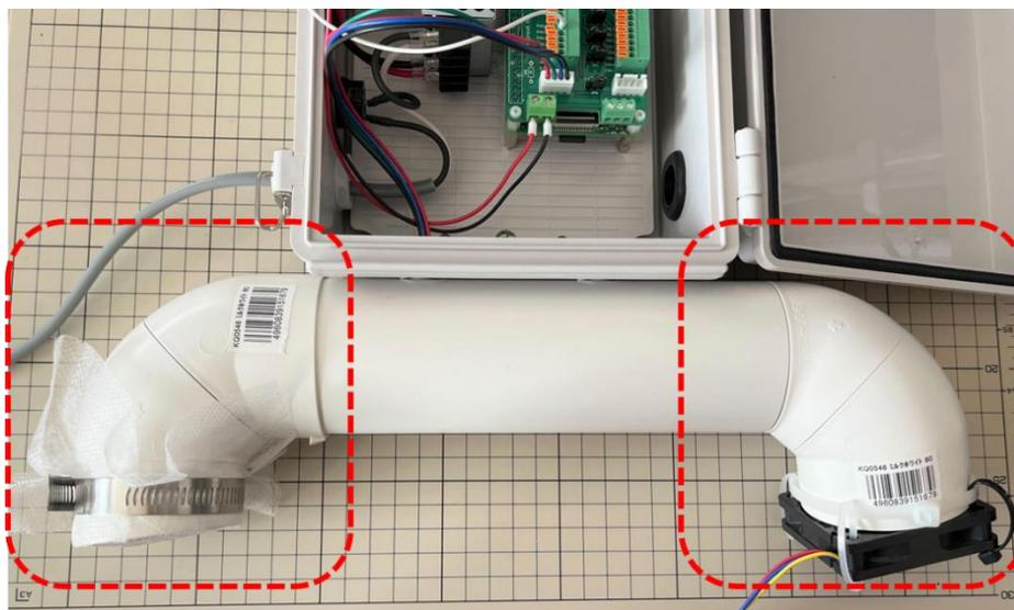
ボックス側面のグロメットに、細いドライバーやニッパなどで、ファンの配線を入れるための穴を開けます。ファンの配線をグロメットの切れ込みからボックスの中へ入れます。
