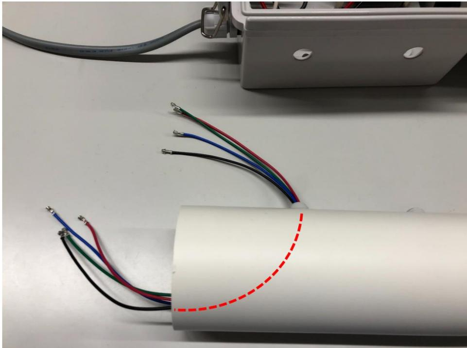
強制通風筒をプラボックスに差し込み、ケーブルグラウンドのリング部分で固定します。
