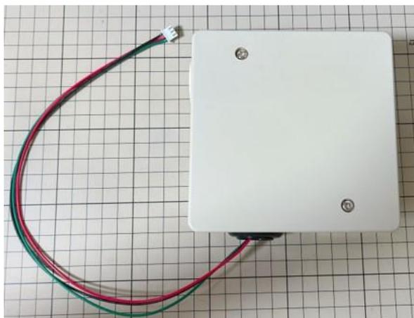
内気象ノードのボックス内へ接続ハーネス（長）の先端を入れ、電圧変換基板の J2 へ接続します。
