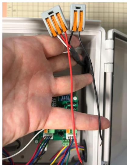
ワンタッチコネクタ (オレンジ色の爪が付いた部品) を使用して結線する箇所があります。使用方法は以下を参照してください。爪を上げるには力がありますが、めったに壊れることはないのでパチッと音が出るまで爪を上げてください。結線する配線は中の銅線が1cm程度見えるくらいに剥いておいてください。結線後は引っ張っても抜けないことを確認してください。
