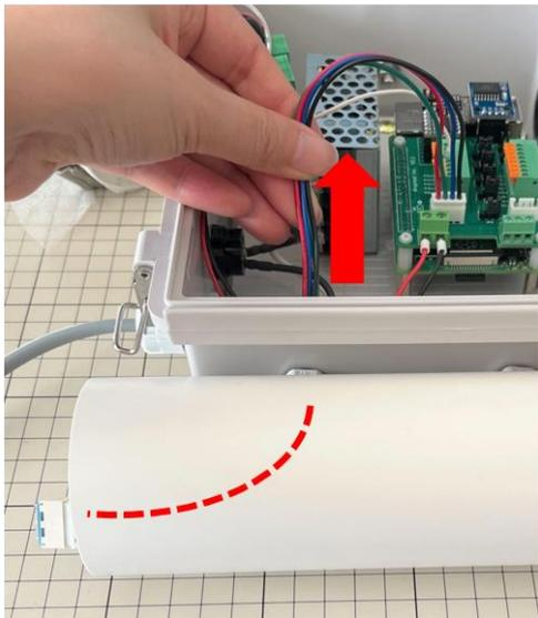
温湿度センサが断熱材の中へ位置するように
