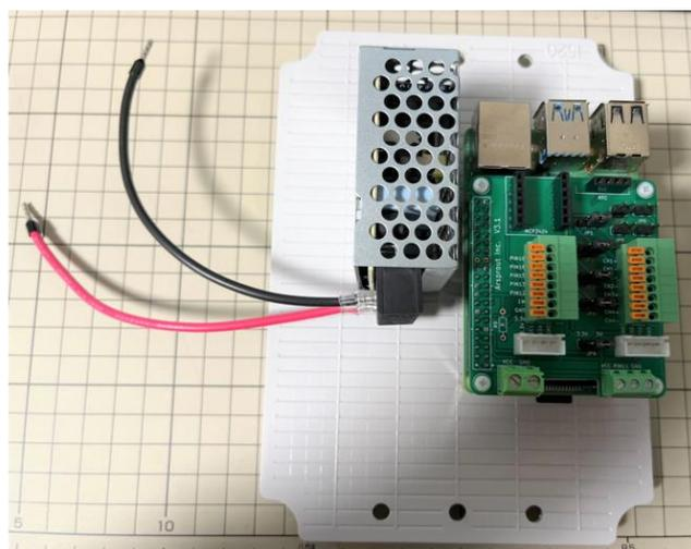
ウォッチドック用配線 (WD2) を内気象ノード専用基板へ取り付けます。
