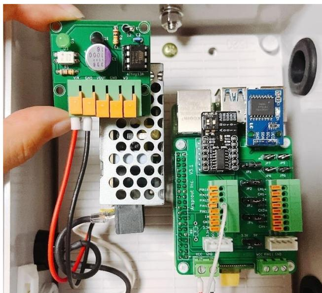
内気象ノード専用基板の赤コードをウォッチドック基板のVOUTへ接続、黒コードをウォッチドック基板のGNDへ接続、白コードをウォッチドック基板のWDへ接続します。
