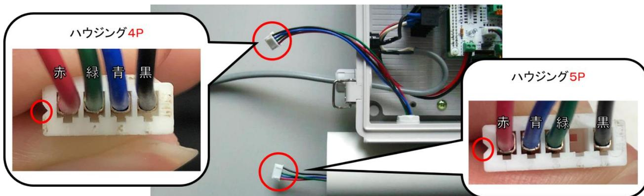
内気象ノード専用基板側にハウジング 4P を差し込みます。カチッと音がするまで差し込み、軽く引っ張っても取れないことを確認してください。
