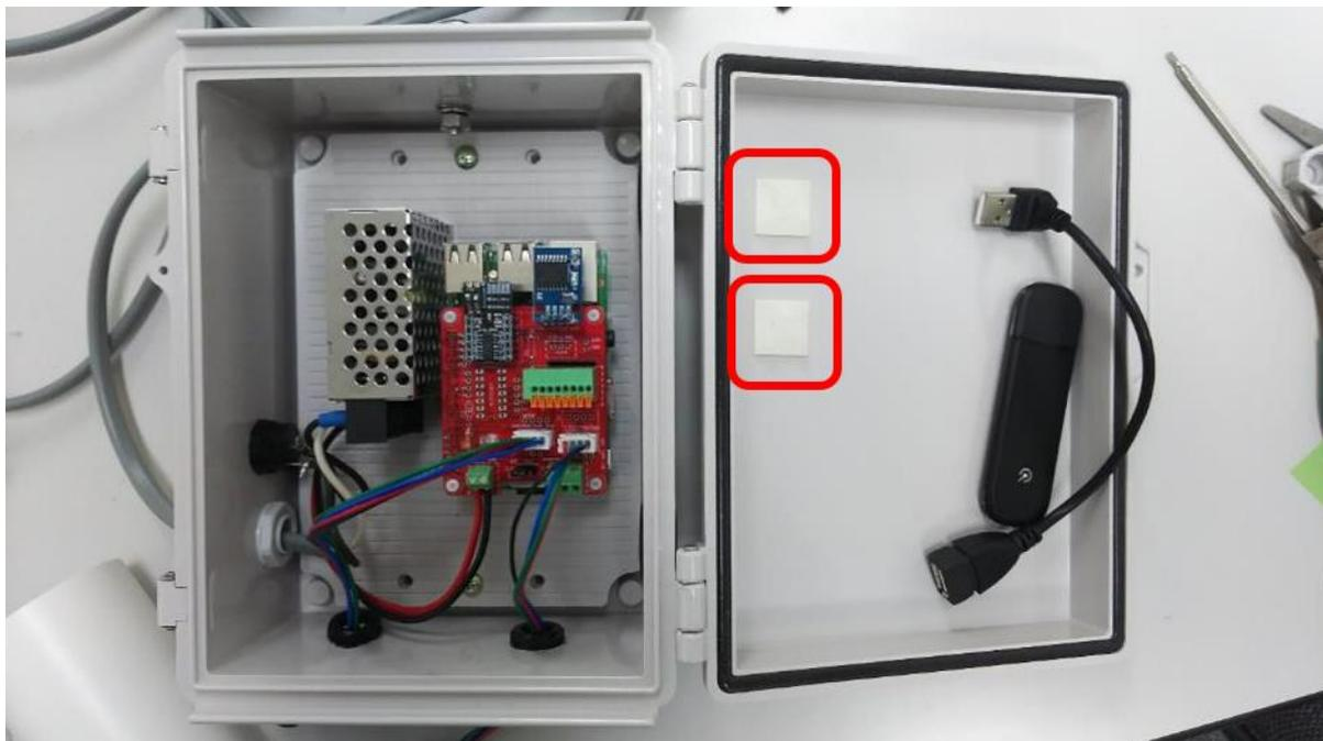
USB L字型ケーブルを Raspberry Pi に差し込み、マウントベースに対して結束バンドで固定します。
