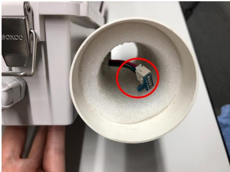
強制通風筒にフィルタ部分とファン部分を差し込みます。
