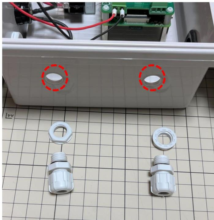
取り外したケーブルグラウンドのキャップ部分を断熱材の穴部分にはめ込みます。上からねじ穴が見えるように押し込んでください。
