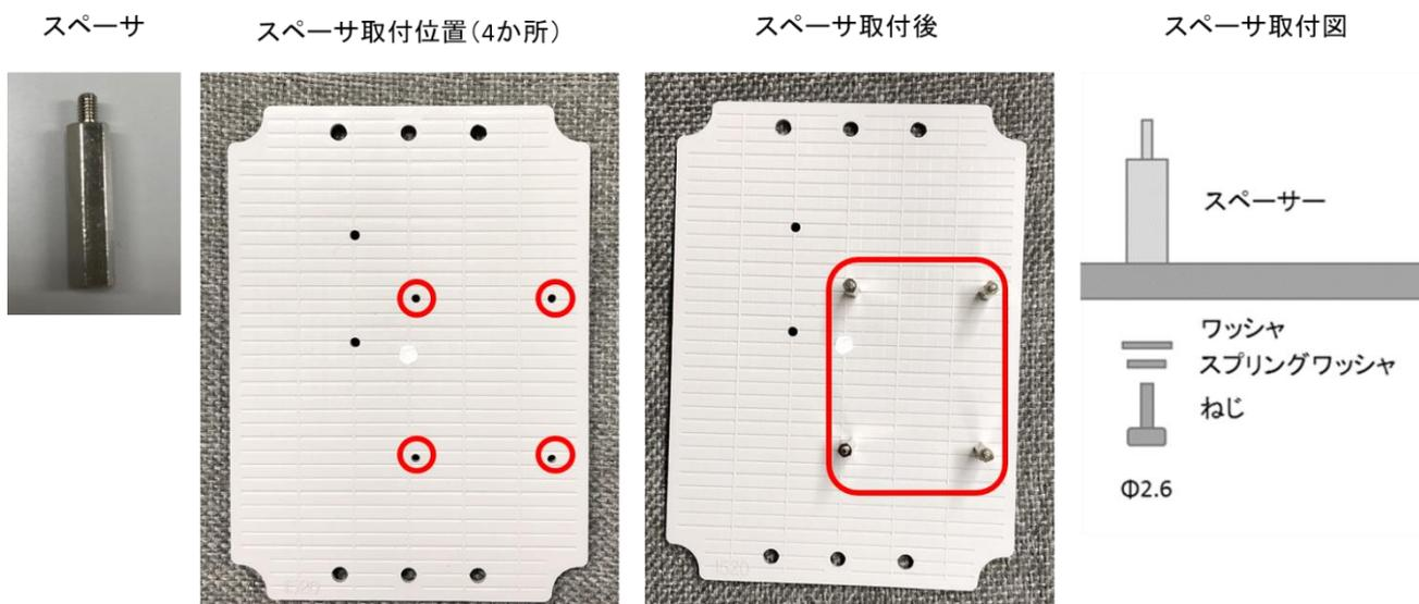
最初にねじにワッシャとスプリングワッシャを通して置き、取付ベースの裏からねじを指し、裏のねじを抑えながらスペーサを取り付けるとスムーズに作業できます。
