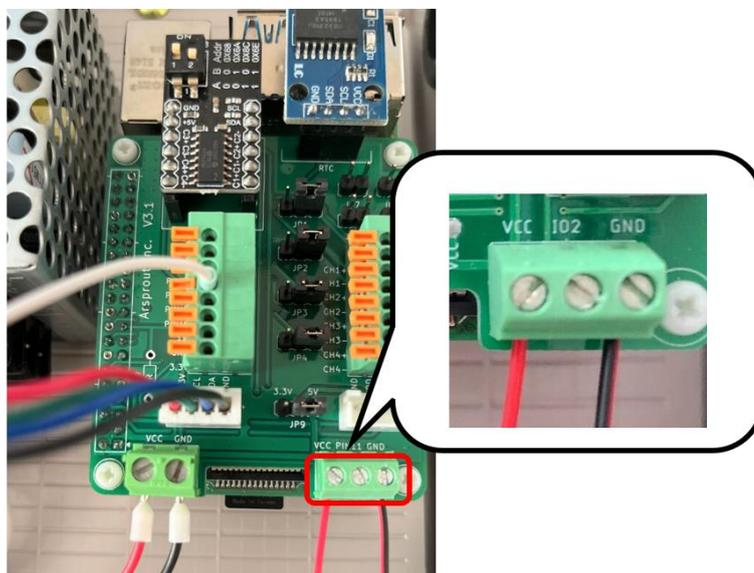
強制通風式温湿度センサオプションの取り付けが完了です。
