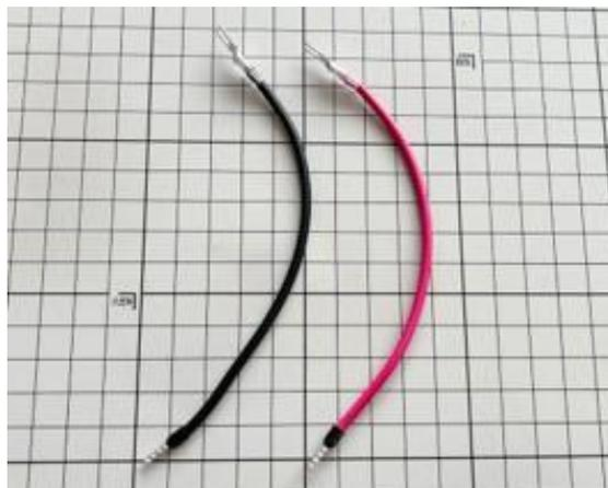
赤コードの Y 端子はスイッチング電源の  $V+$  へ差し込みます。黒コードの Y 端子はスイッチング電源の  $V-$  へ差し込みます。スイッチング電源の端子台は、ねじを緩めると端子台の隙間が開くので、差し込んだ後はねじを締めて固定してください。
