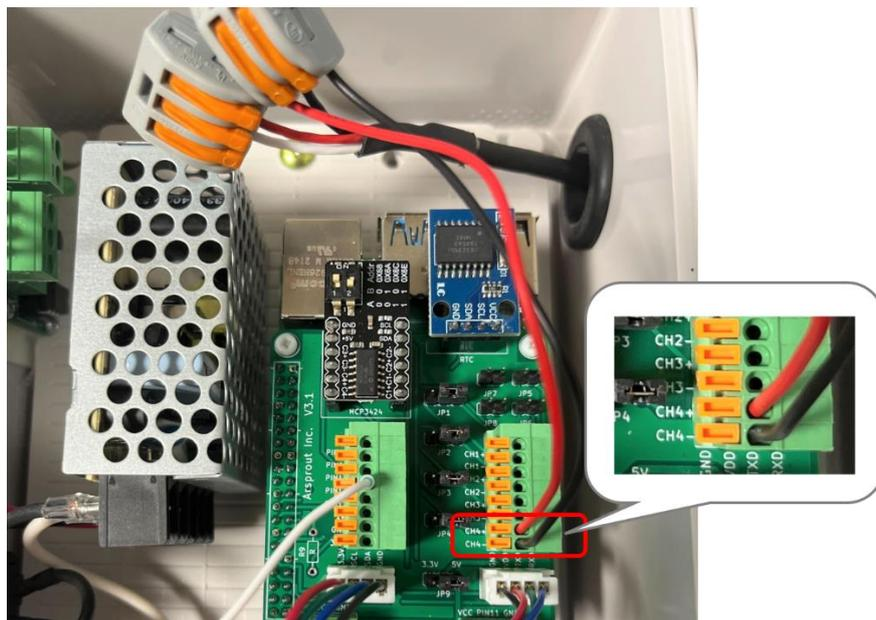
内気象ノード専用基板の JP8 にジャンパピン (S41) を差します。
