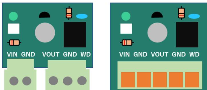
スイッチング電源の赤コードをウォッチドック基板のVINへ接続、スイッチング電源の黒コードをウォッチドック基板のGNDへ接続します。
