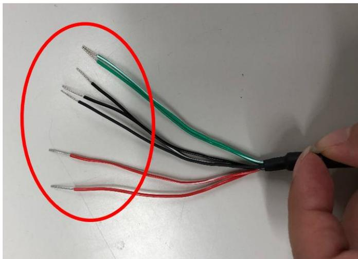
土壌センサのケーブル端はグロメットを通してプラボックスの中へ入れ、土壌水分センサの端の赤線と赤白線をワンタッチコネクタへ差し込みます。
