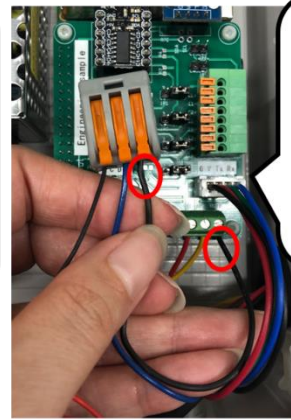
接続用黒配線 を端子台とワンタッチコネクタ へ差し込む
