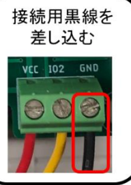
接続用黒配線 を端子台とワンタッチコネクタ へ差し込む
