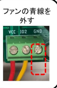
ファンの青線 を外し、ワンタッチコネクタへ 差し込む(※)
