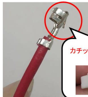
爪がついている方を凸にあわせて差し込む
