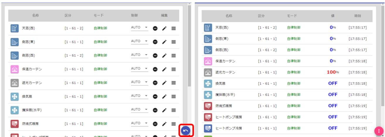
実際に制御する予定のアクチュエータだけが残ったら、次にそれぞれのアクチュエータと、製作を終えた「ArsproutDIY キット 2 制御ノード」のリレー動作を連動させていきます。これには「リレー」と「インプット」の割り当てが必要です。ここでは具体的に、暖房機と天窓を例にリレーとインプットの割り当てを行います。
