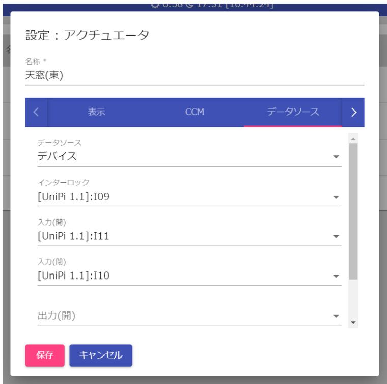
次に、天窓アクチュエータが開動作をした時に Relay5 が動作するように、また天窓アクチュエータが閉動作をした時に Relay6 が動作するようにします。以下のように設定します。
