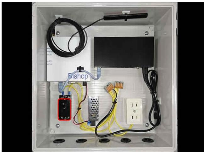
モバイルルータ内のネットワークハブに各ノードを LAN ケーブルで接続します。設定用 PC も接続してください。
