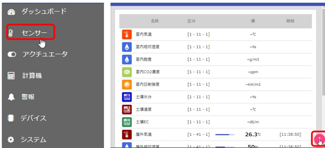
接続していないセンサの計測項目の編集の
