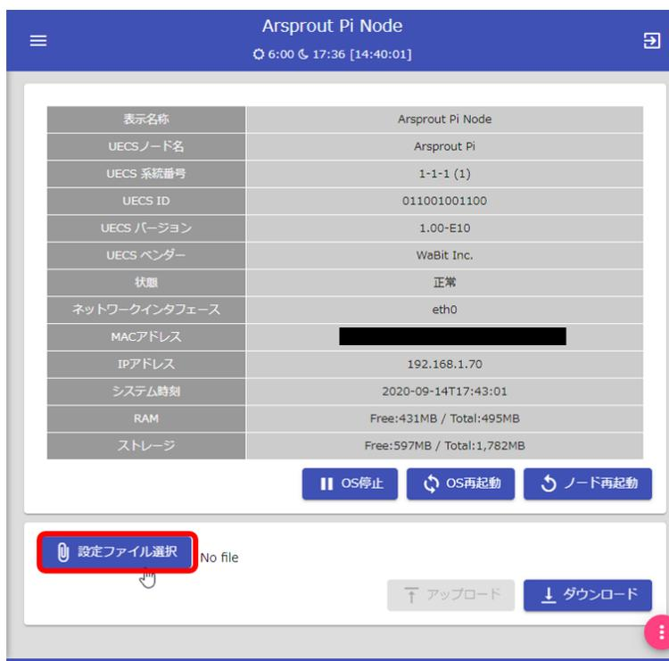
制御ノードの場合は、スイッチ基板のバージョンを確認してファイルを選択してください。バージョンはスイッチ基板の左端に印字されています。
