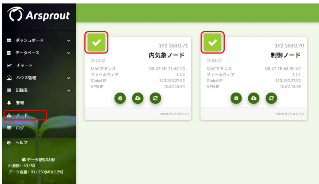
次に、ノードに接続しているセンサ類がクラウド連携できているか確認を行います。左メニューから「ハウス管理」の下にあるハウスをクリックします。「計測値」タブにセンサ類が表示されます。ここには Arsprout-Pi のクラウド連携設定で有効にチェックを入れたものが表示されます。Arsprout クラウドではここに表示されるものを「計測値」と呼びます。右上のリストからハウス (room) や区分 (region) を選択することができます。
