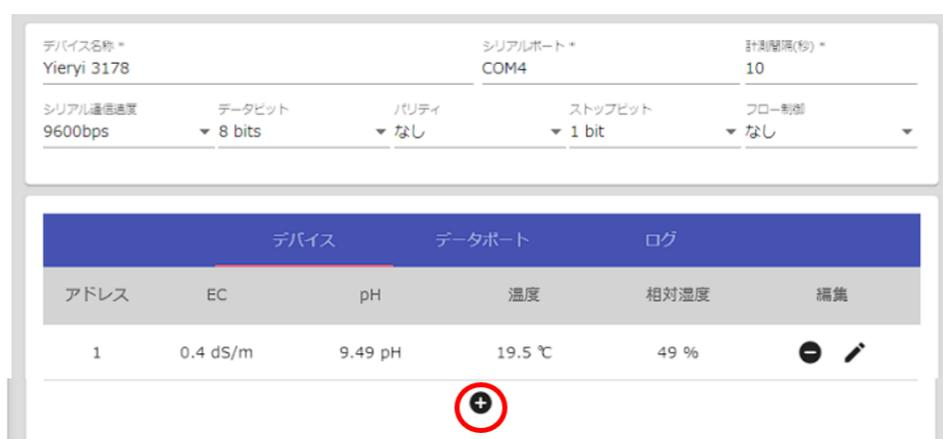
アドレス「1」で検索し、正常に動作していれば、値が表示されます。追加をクリックしてください。
