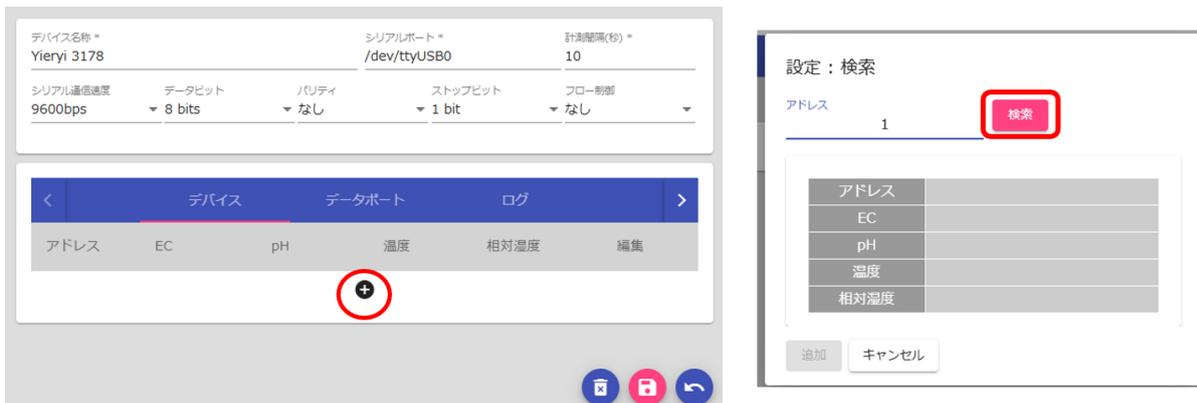
正常に動作していれば、値が表示されます。(空中ではECは空です。)追加をクリックしてください。
