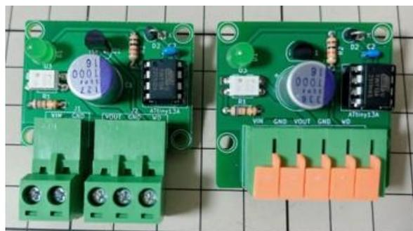
左：旧ウォッチドック基板 右：新ウォッチドック基板
