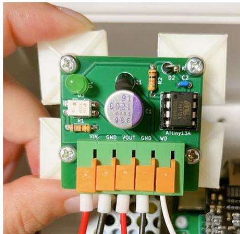
貼り付けボス裏の保護シートを剥がし、ウォッチドック基板をプラボックスの中へ取り付けます。
