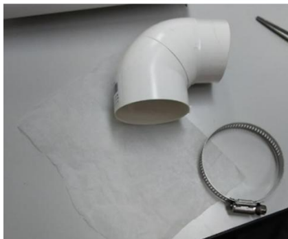
不織布を被せてステンレスホースバンドで固定
