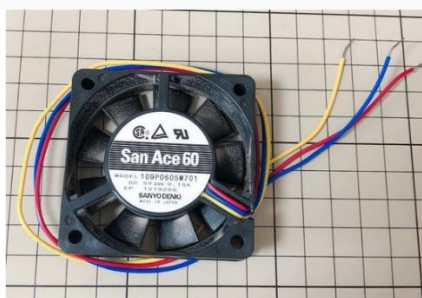
配線が赤線、青線、黄色線3本のファン
