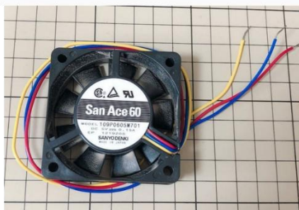
配線が赤線、青線、黄色線3本のファン
