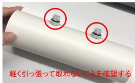
ケーブルグランド取付
