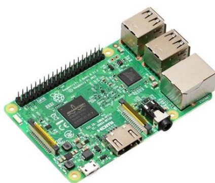
図 1 : Raspberry Pi 3 Model B
