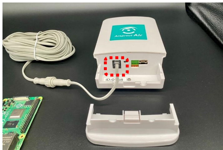
図 5 : Air ノード（親機）通信ケーブル接続
