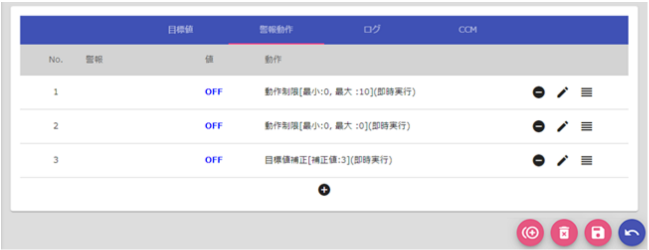
図 37：PID 警報動作一覧編集画面
