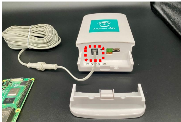
図 5 : Air ノード（親機）通信ケーブル接続
