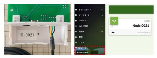
Air ノード画面の右下の編集アイコン[11]をクリックし、Air ノード ID のデバイスに表示された編集アイコン[11]をクリックすると設定ダイアログが表示されます。
