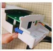
基盤をネジで留め、蓋を取り付けます。 ※センサ線は蓋の穴から外に出します。
