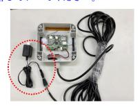
Air クラウドゲートウェイとバッテリーを電源ケーブルで以下の通り接続します。
