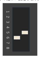
Air クラウドゲートウェイを使用する為、SW3 の DIP7 を以下の通り設定します。また、Air ノードが LED 点灯するように DIP 8 を以下の通り設定します。
