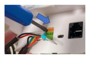
日射センサを接続する場合は、電池右横にあるジャンパプラグを 2 か所差しなおします。 ジャンパプラグは真上に引くと外れます。上から 3 番目と 4 番目の 2 か所のジャンパピンの真ん中と右 をジャンパするようにジャンパプラグを差します。(基板のバージョンによってジャンパピンの印字が異なる場合があります。)
