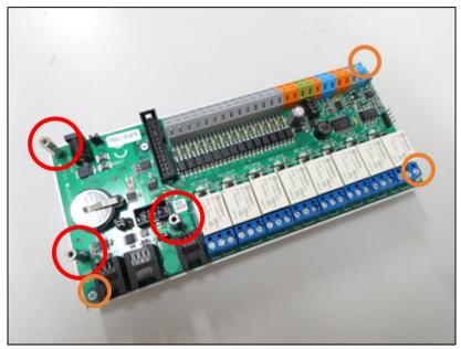
赤: M2.5 x 18mm スペーサ: 3 箇所 橙: M2.5 x 5mm ネジ : 3 箇所 UniPi 基板に 26 ピンフラットケーブル (C5) の 2 本線を確認します。下図の様に、フラットケーブルの側面を見て、2 本線の上の方を①、下の方を②として以降説明します。
