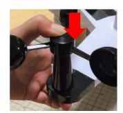
風速カップを引っ張っても取れない程度に、風速カップ横のねじを締めます。<mark>息を吹きかけて風速カップが回転することを確認</mark>してください。
