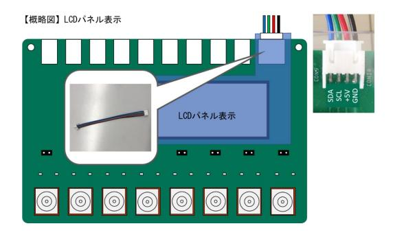
その他のソケットは以下の通り、ソケットとピンとスイッチ3つで1組になっています。このソケット にアクチュエータ制御用の配線を取り付けていきます。
