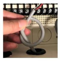
感雨センサ赤線を端子台下段右から 11 番目に結線し、感雨センサ白線を端子台下段右から 10 番目に結線し、感雨センサ黒線を端子台下段右から 9 番目に結線します。軽く引っ張っても取れないことを確認してください。
