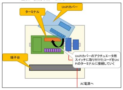
スイッチ基板の ON/OFF、開閉のコード先端のフェノール端子部分を UniPi 基板の灰色ターミナルに 結線します。UniPi 基板をボックスから出して作業してください。
