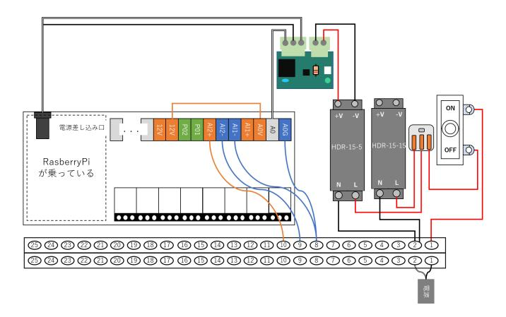
C25 の赤配線 30cm と黒配線 30cm を使用します。(片方がフェノール端子、片方が Y 端子)
