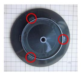
雨受けカップの爪とセンサ本体の溝を合わせ、<mark>雨受けカップを下に抑えながらカップを左に回します。</mark> 軽く引っ張っても取れないことを確認してください。
