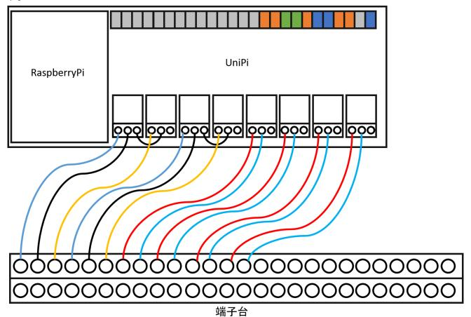
まず、端子台にコードを接続します。青、赤、黒、黄コード(C16、C19)を使用します。コードの端は Y 端子側と I 端子がついています。以下の通り、端子台に Y 端子側を接続します。黒コード 2 本は後
