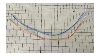
オレンジ配線を UniPi ターミナルの AI2+に接続し、端子台上段右から 10 番目に接続します。青配線は UniPi ターミナルの AI2-へ接続、端子台上段右から 9 番目へ接続します。
