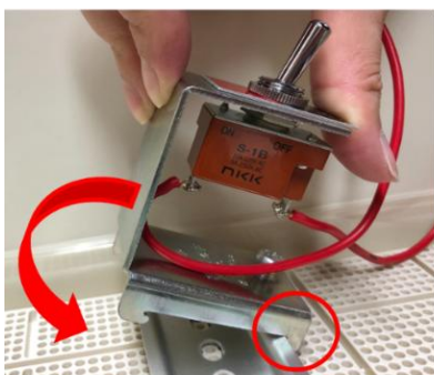
スイッチ台の爪をレールに引っ掛けて下す
