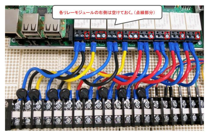
残りの黒コード2本のY端子側をI端子風にカットします。
