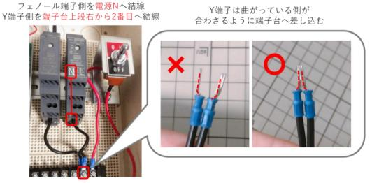
ワンタッチコネクタ (C26) と電源用配線 18 cm赤 2 本 (C25) を以下の通りに結線します。
