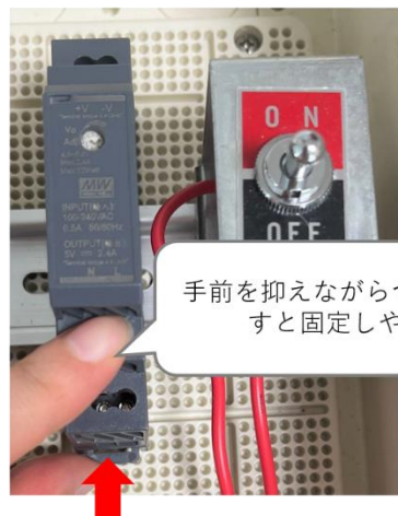
つまみを戻してDINレールに固定
