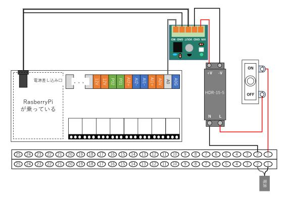
C20 のオレンジ短配線で、UniPi ターミナルの 12V と A0V を結線します。 C20 の青配線 2 本で、UniPi ターミナル「AI1-」「A0G」と端子台上段右から 8 番目を結線します。
