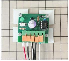
以下の通り、DC コードは Raspberry の電源差込口へ接続します。 白線は UniPi ターミナル AO へ結線します。赤線は電源の+V へ、黒線は電源の-V へ結線します。
