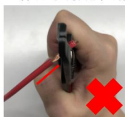
斜めにして引くと中の銅線が削れる恐れがある
