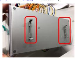
以下の通り、電源の左隣りに取り付けます。(配線は省略しています)
