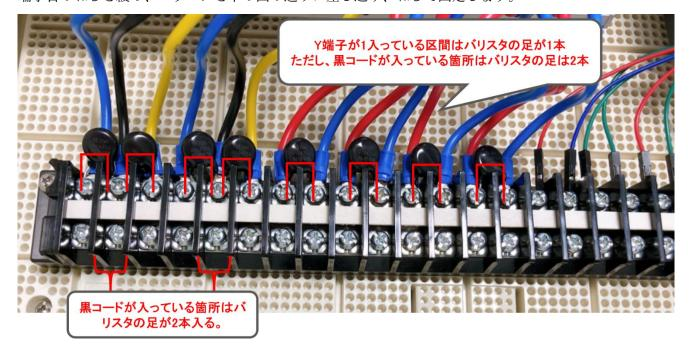
リレーモジュールへ I 端子側を接続します。リレーモジュールはネジを緩めると側面に隙間ができるのでその隙間に I 端子を挟んでネジで固定します。以下の通りリレーモジュールに接続します。
