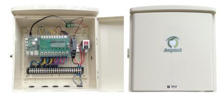
UniPi 基板にカバーを取り付ける際、ケーブルを挟まないようご注意ください。以下のようにフラットケーブル側に寄せて、2 本線がスイッチ基板の隙間に入るように調整してください。
