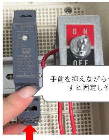
次に電源スイッチの配線を端子台と AC アダプタに接続します。電源スイッチ ON の Y 端子を端子台上段右 1 番目に接続し、電源スイッチ OFF のフェノール端子を AC アダプタの L に接続します。
