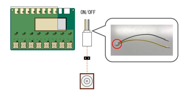
開閉 1 系統の動作制御には、ソケットとジャンパピン無ピンとスイッチが各 2 つを使用します。右のソケットにはインターロック信号入力用ハーネス(灰)を取り付け、左のソケットには開閉信号入力用ハーネス(黄青)を取り付けます。(C10)
