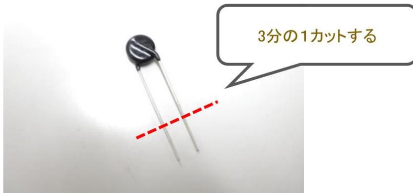
端子台のねじを緩め、バリスタを下図の通りに差し込み、ねじで固定します。
