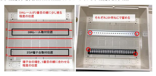
ネジは穴に合わせてセットします。上から力を加えてねじ込んでください。
