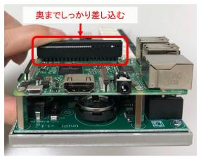
DIN レールに Raspberry Pi 装着済みの UniPi 基板を仮置きします。UniPi 基板への結線をする際はボックスから出して作業してください。
