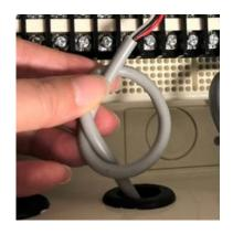
日射センサの<u>黒線を端子台下段右から</u>8番目に接続します。日射センサの<u>白と赤線は端子台下段右から</u>7番目に接続します。軽く引っ張っても取れないことを確認してください。
