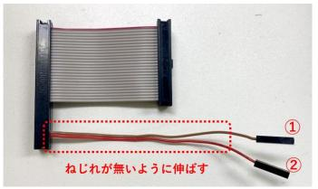
UniPi 基板に 26 ピンフラットケーブル (C5) を下の図の通りに取り付けます。 各ソケットは<mark>隙間が空かないように差し込んでください。</mark>(フラットケーブルのキャップが壊れやすいので外す際は注意してください。外す場合はラジオペンチを使うとスムーズです。)
