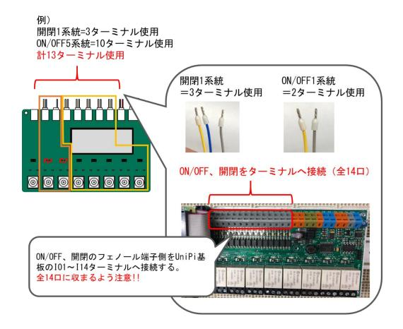
ON/OFF、開閉の組み合わせ別の接続方法を紹介します。実際に接続するアクチュエータに合うようにスイッチ基板へハーネスを接続してください。
