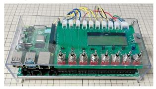
カバーを取り付ける際、ケーブルを挟まないようご注意ください。以下のようにフラットケーブル側に 寄せて、2本線がスイッチ基板の隙間に入るように調整してください。
