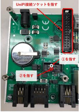
UniPi 基板に挿し込んだ後は、フラットケーブルの①と②が図の通り場所に刺さっているか、再度確認してください。
