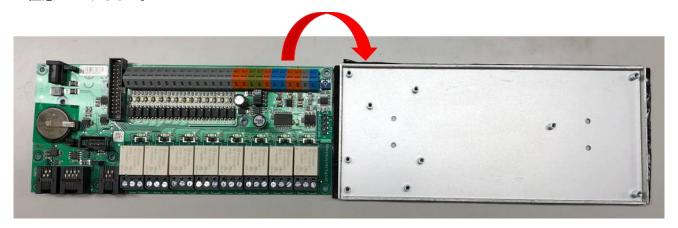
UniPi 基板を DIN レールホルダーに対して、M2.5 x 18mm スペーサと M2.5 x 5mm ネジ(C5 の袋に入っています。)で固定します。
