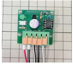
ウォッチドック基板 (WD1) の四隅に、取り付けボスをねじで固定します。(WD3)
