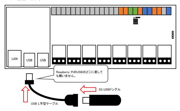
接続したら、USB L 字型ケーブルを、結束バンドとマウントベースで制御ノードに適当な位置に留めます。固定の際は、出来るだけ大きな電気が流れる線から遠い位置に固定してください。この固定作業は行わなくても構いません。
