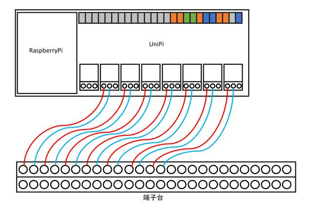
開閉1系統 ON/OFF5系統の場合
