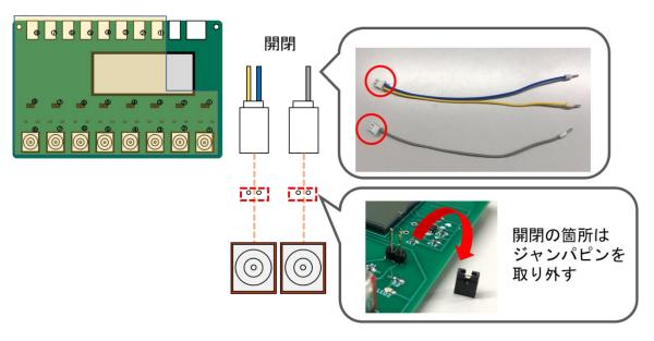
この ON/OFF、開閉の 2 つの結線を組み合せる事で、対応するアクチュエータ構成を変えることができます。組み合わせ例は以下の通りです。
