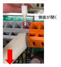
スイッチ基板の ON/OFF(灰黄)、開閉(灰、青黄)の配線を右詰めで UniPi 基板の灰色ターミナルへ接続します。
