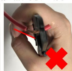
斜めにして引くと中の銅線が削れる恐れがある
