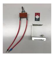
ON/OFFプレートとスイッチの ON,OFFの向きが合うように注意
