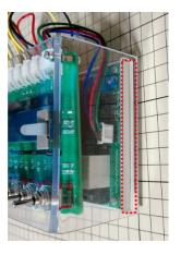
UniPi 基板の裏にアタッチメント (C4) を取り付けます。アタッチメントの爪の部分 (4 箇所) がカチッと音がするまで差込んで下さい。その後、さらに押し込むとカチッと返しのかかる音がします。(アタッチメントを引っ張っても取れないことを確認してください。
