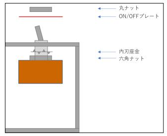
DIN レールに電源スイッチ台を固定します。UniPi 基板とスイッチ台の間は AC アダプタを取り付ける 為少々間を空けておいてください。
