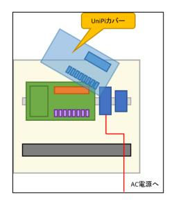
スイッチ基板を制御予定の機器(天窓、暖房など)に合うように結線して UniPi 基板カバーに固定します。ここで結線したコードは機器の動作制御に使用します。
