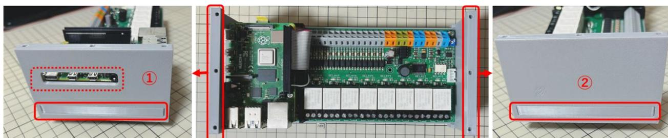
クリアカバーを乗せ、側板のネジ穴とクリアカバーの穴が合うように位置を調整します。
