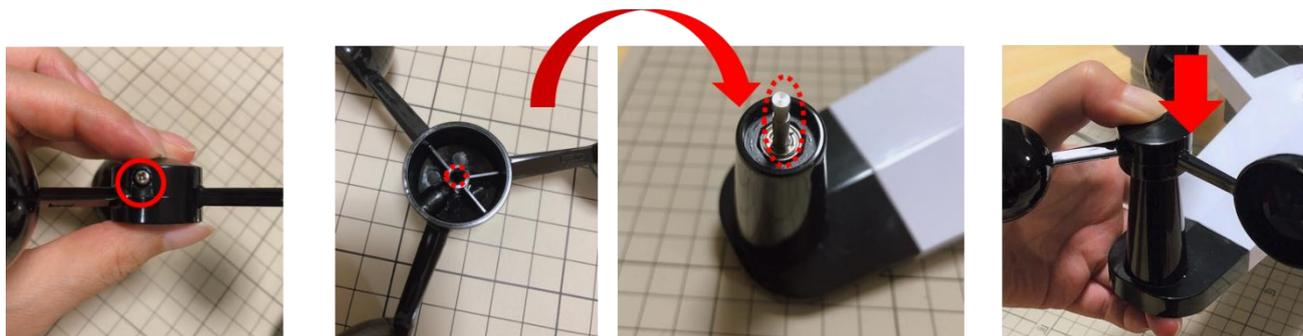
風速カップを引っ張っても取れない程度に、風速カップ横のねじを締めます。息を吹きかけて風速カップが回転することを確認してください。
