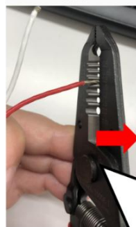
斜めにして引くと中の銅線が削れる恐れがある
