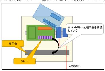
次は、UniPiのリレーと端子台を結線します。C16、C19の青、赤、黒、黄コードを使用します。コードの端はY端子側とI端子がついています。端子台にY端子を接続し、リレーにI端子を接続します。
