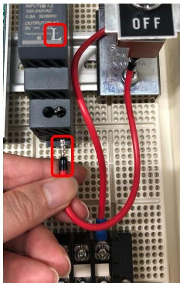
次は、電源用配線コード（C7）を端子台と AC アダプタに取り付けます。
