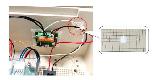
以上でウォッチドック基板の取り付けが完了です。
