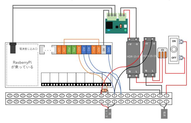
電源(HDR-5)のLに結線していた赤線を取り外します。
