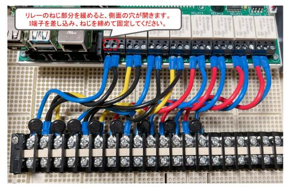
接続方法はスイッチ基板同様に、ON/OFF、開閉アクチュエータの組み合わせよって異なります。実際 に接続するアクチュエータに合うように結線してください。
