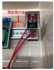
以下の通り DIN レール上に電源アダプタを固定します。軽く引っ張っても取れないことを確認してください。
