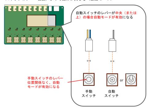
開閉アクチュエータを手動で操作する場合は、自動スイッチのレバーを下にします。手動で開く場合は、 手動スイッチのレバーを上に倒します。手動で閉じる場合は、スイッチのレバーを下に倒します。手動の 開閉動作を停止する場合は手動スイッチのレバーを中央にします。自動スイッチのレバーが下に倒れて いる間は自動モードが無効です。手動モードでアクチュエータを操作後に自動モードでアクチュエータ を動作させたい場合は、忘れずに自動スイッチのレバー位置を中央(または上)にしてください。
