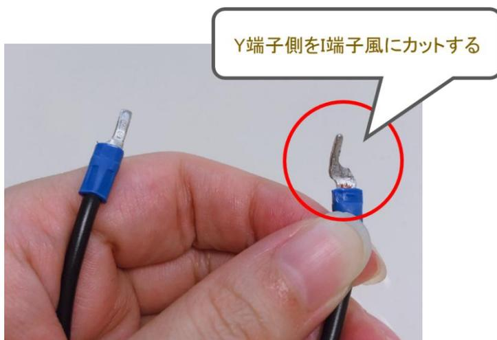
I 端子風にカットした黒コードを、以下の様にリレーモジュールに接続します。
