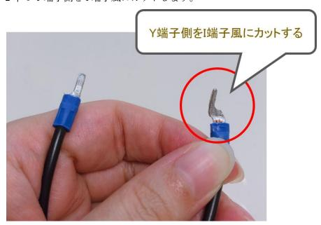
I端子風にカットした黒コードを、以下の様にリレーモジュールに接続します。
