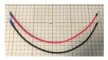
HDR-15-15 の+V へ赤配線のフェノール端子、-V へ黒配線のフェノール端子を差し込みます。 Y 端子側を端子台上段へ差し込みます。赤配線は右から 11 番目、黒配線は右から 9 番目に差し込みます。
