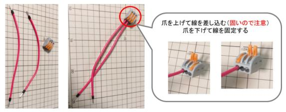
ワンタッチコネクタを取り付けた配線とスイッチ OFF 側の配線を以下の通りに結線します。
