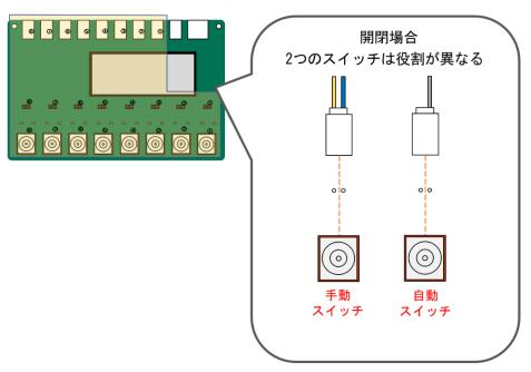
自動スイッチのレバー位置を中央(または上)にすることで、接続している開閉アクチュエータの動作が「自動モード」になります。(手動スイッチのレバー位置は関係なく自動モードになります。)
