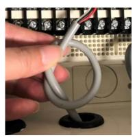
延長ケーブルの黒線を端子台下段右から8番目に接続します。延長ケーブルの白と赤線は端子台下段右から7番目に接続します。軽く引っ張っても取れないことを確認してください。
