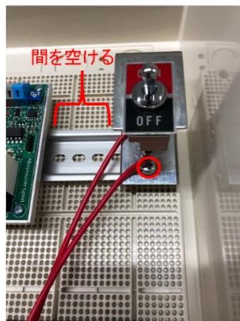
以下の通り DIN レール上に AC アダプタを固定します。軽く引っ張っても取れないことを確認してください。
