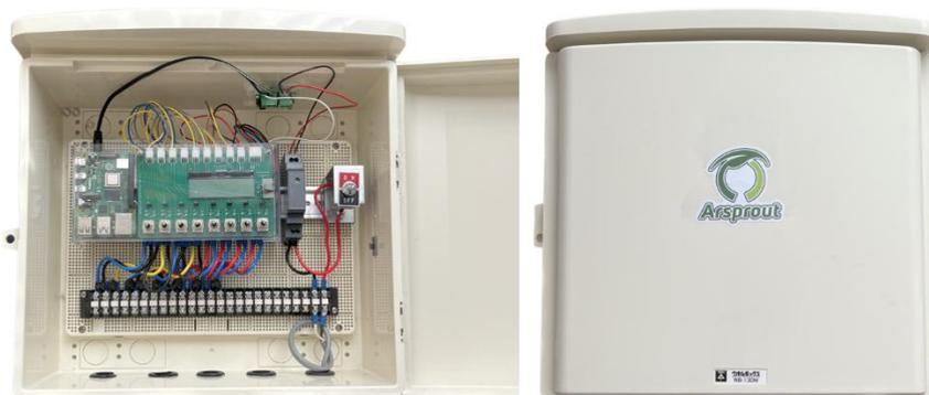
UniPi 基板にカバーを取り付ける際、ケーブルを挟まないようご注意ください。以下のようにフラットケーブル側に寄せて、2本線がスイッチ基板の隙間に入るように調整してください。
