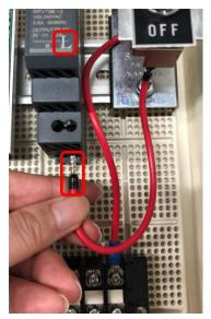
次は、電源用配線コード(C7)を端子台と AC アダプタに取り付けます。 電源用配線コードは Y 端子を端子台上段の右から 2 番目に接続し、フェノール端子を AC アダプタの N に接続します。
