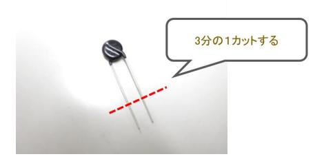
端子台のねじを緩め、バリスタを下の図の通りに差し込み、ねじで固定します。
