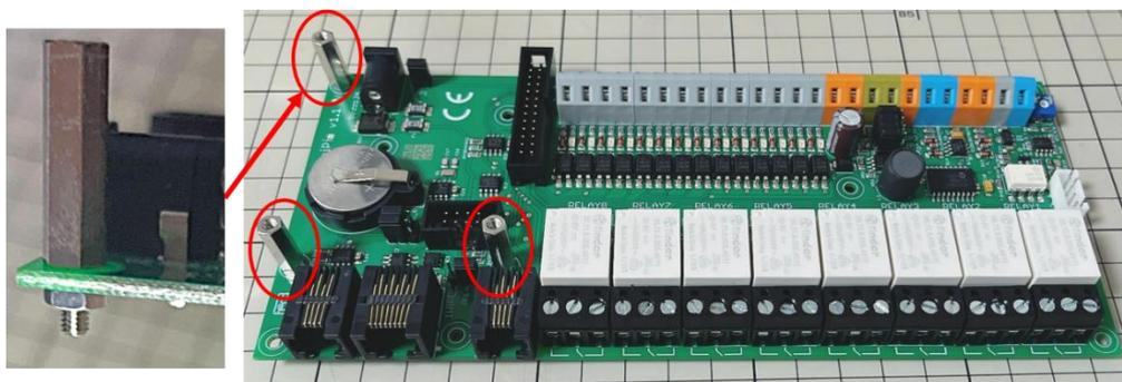
UniPi 基板を以下の向きで UniPi ホルダーの上に置きます。
