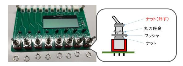
スイッチ基板に UniPi 基板カバーを下図の通りに取り付けます。カバーを挟み、スペーサにねじ (C12) を取り付け、トグルスイッチのナットを取り付けます。
