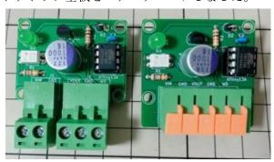
左:旧ウォッチドック基板 右:新ウォッチドック基板
