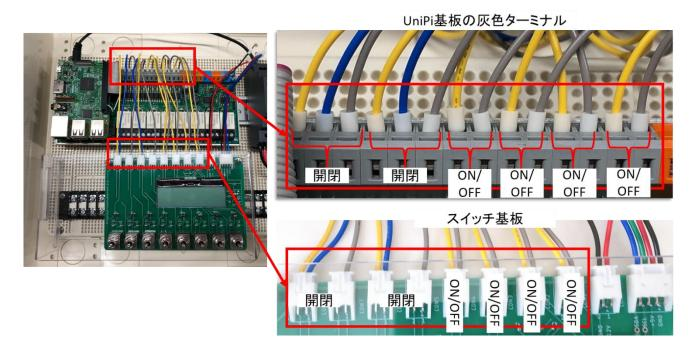
スイッチ基板と同じ順番でターミナルへ接続します。ON/OFF、開閉を 1 組ずつ確認しながら配線してください
